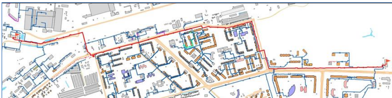
Рисунок 7.46 – Резервная схема теплоснабжения зоны К-45 через переемычку 2Ду250
