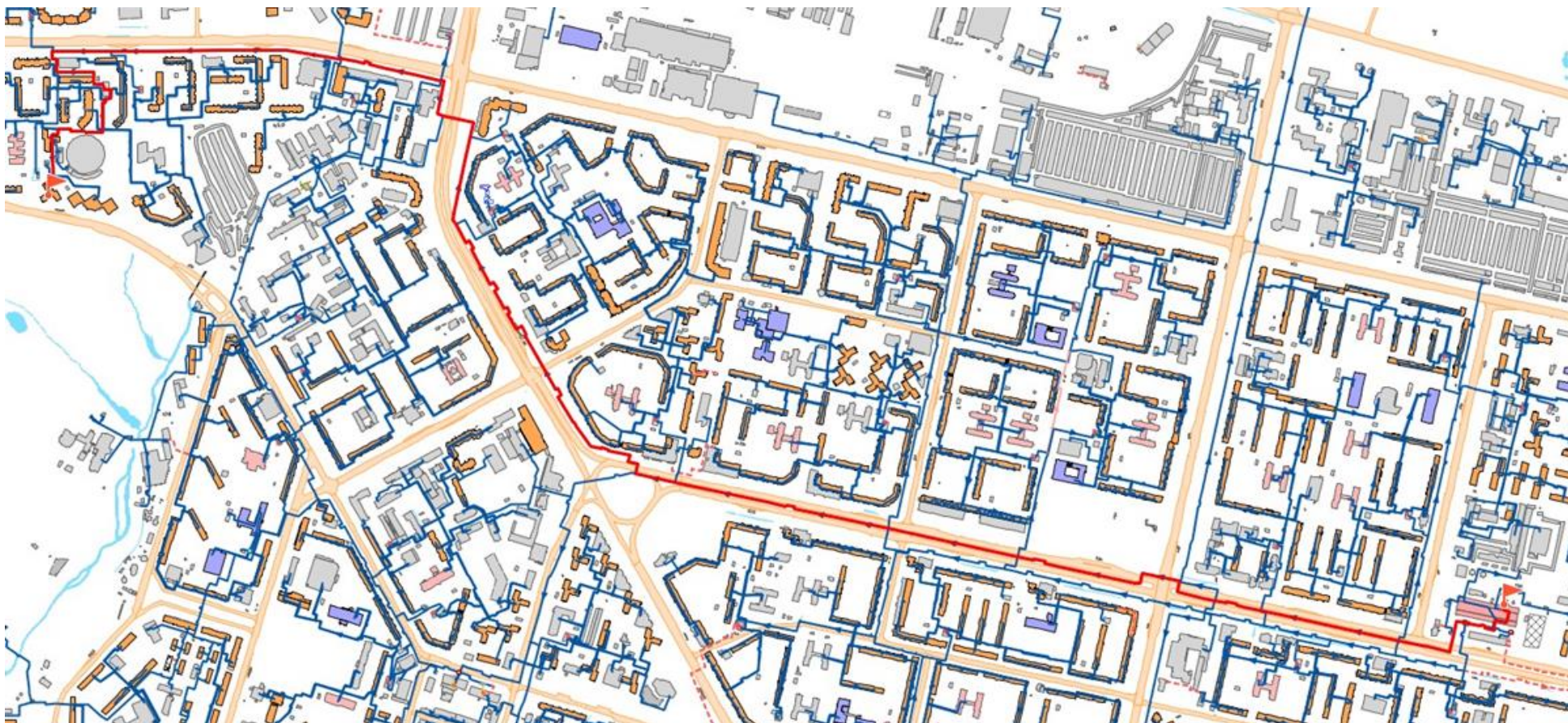
Рисунок 7.39 – Путь построения пьезометрического графика от ПКТС до потребителя с наихудшими параметрами гидравлического режима (отопление и ГВС – уровень аварийной брони, вентиляция – полное отключение)
