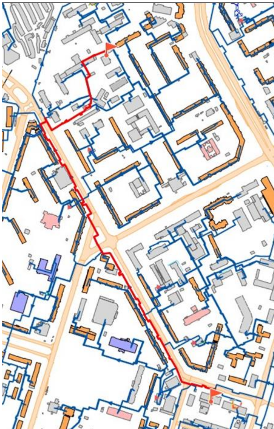
Рисунок 7.7 – Путь построения пьезометрического графика от Котельной №2 до потребителя с наихудшими параметрами гидравлического режима
