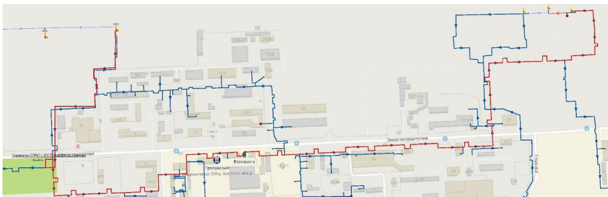
Рисунок 7.23 – Путь теплоносителя при аварии теплопровода СГРЭС-2 – Промзона по перспективной перемычке
